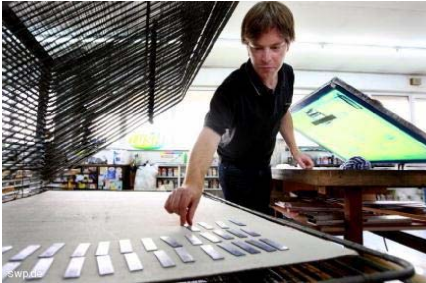
Zum Trocknen kommen bedruckte Schilder in die so genannte Trockenhorde (links). Volker Maendle hat den Schildern die Farbe durch ein Sieb aufgedruckt (hinten rechts). Foto: Oliver Schulz
